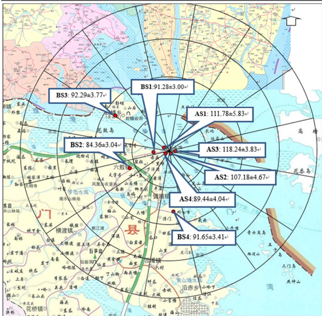
图 2-1 2023 年第二季度固定连续监测点及环境 \gamma 辐射空气吸收剂量率均值 (nGy/h)
